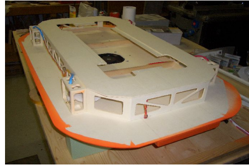
Abbildung 2.4-3: Rumpf – Rohbau Unterseite
