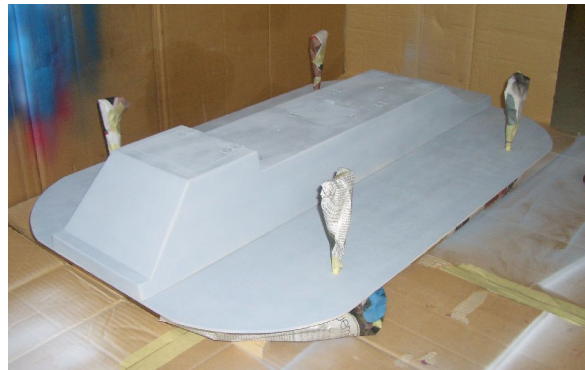
Abbildung 2.12-1: Grundierung des Rohbaus
